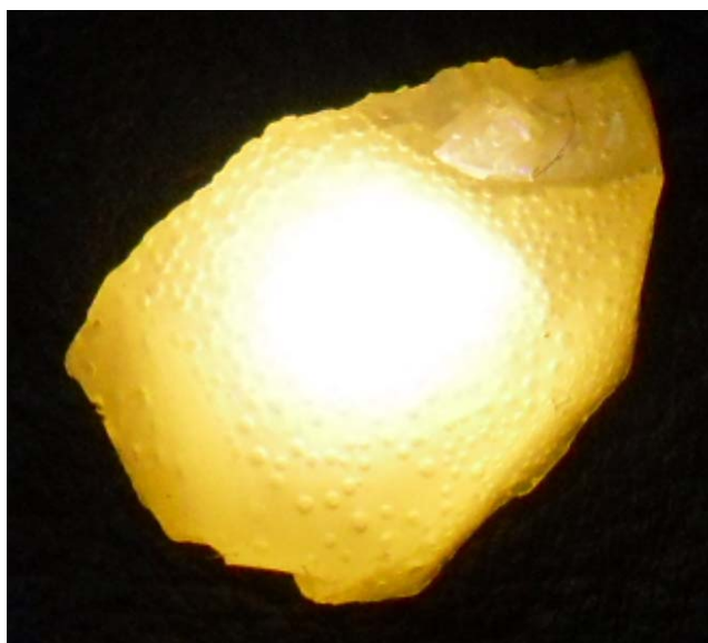
Рис.1. Свечение нанокompозита на основе CdS при УФ-засветке.
